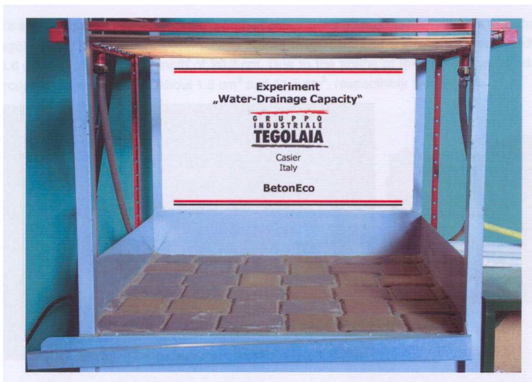
fig. 2 Pavimentazione “BetonEco” senza caduta della pioggia
