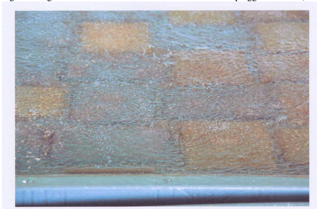
Fig. 5 Dettaglio del massello “BetonEco” con intensità della pioggia = 1000 l/(s.ha)
