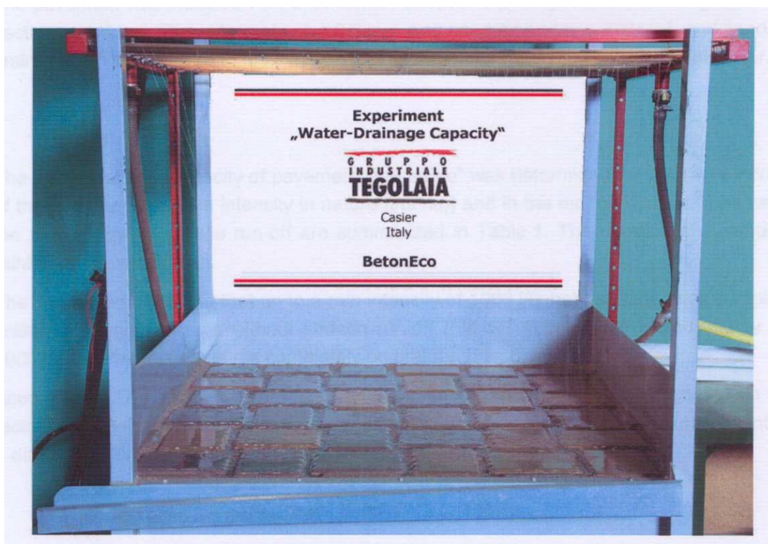
fig. 3 Pavimentazione “BetonEco” con caduta della pioggia
